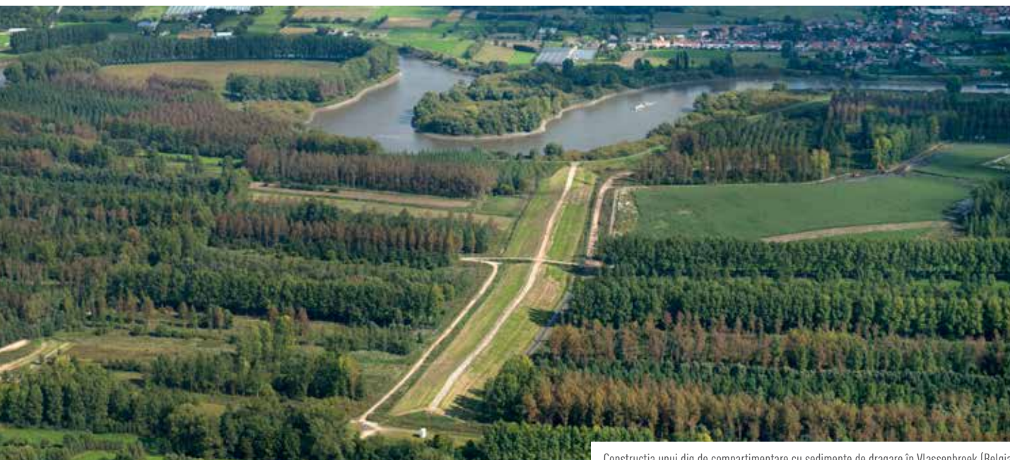
Construcția unui dig de compartimentare cu sedimente de dragare în Vlassenbroek (Belgia)
